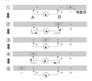
A を基準とした B の電位変化は、①、③、⑤では、両電極間の電位変化がないため、0 となる。②と④では、電位差を生じる。A に対して B は、②ではマイナス (-)、④ではプラス (+) となる。このため、オシロスコープの波形も反対になる。したがって、オシロスコープの波形は、① $\rightarrow$ ⑤の順に、
